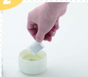
下蓋を外し、底のくぼみに合わせて、MH-1（水素発生剤）をセットしてください。
