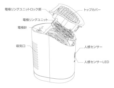
快適にご使用いただくため、定期的なお手入れをしてください。 汚れがひどくなると、電源ボタンLED(赤)が点灯し運転が停止します。 (ご使用環境にもよりますが、月に1~2回程度のお手入れをおすすめします。)
