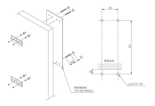
※外壁強度が給湯器の取付けに十分でない場合に使用
