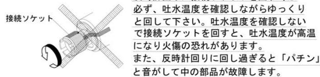
反時計回りに接続ソケットを回す時は必ず、吐水温度を確認しながらゆっくりと回して下さい。吐水温度を確認しないで接続ソケットを回すと、吐水温度が高温になり火傷の恐れがあります。また、反時計回りに回し過ぎると「パチン」と音がして中の部品が故障します。
