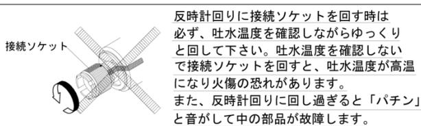
1. 「サーモ本体」上部の青ラインと、接続ソケットの青ラインを合わせると吐水温度が40℃となるように工場検査時に調整しています。
