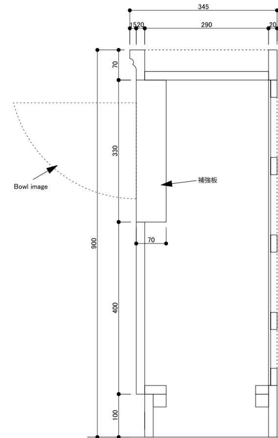
※取り付けのシャンプーボールに合わせ給排水用の開口を開けて下さい。
