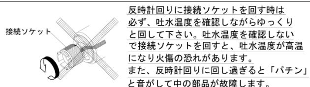
1. 「サーモ本体」上部の青ラインと、接続ソケットの青ラインを合わせると吐水温度が40°Cとなるように工場検査時に調整しています。
