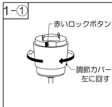
①調節カバーを左に回して、赤いロックボタンが見えるまで調節カバーを下げてください。
