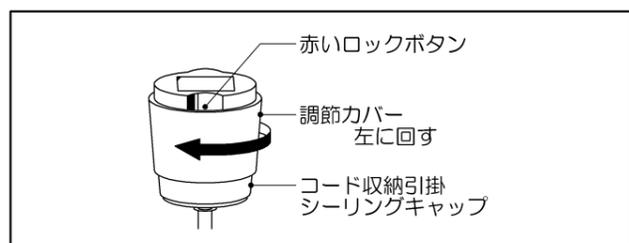
①コード収納引掛シーリングキャップの調節カバーを左に回して、赤色のボタンが完全に見えるまで下げてください。
