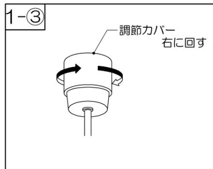
③コード収納引掛シーリングキャップの調節カバーが天井面に当たるまで右に回してください。
