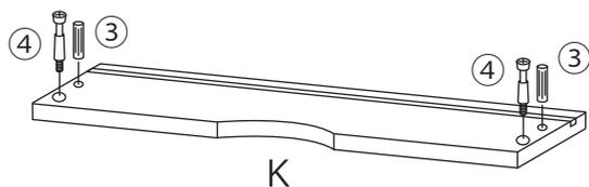
2 L引出し背板のダボ穴に③木ダボ小を差し込み、MN引出し左右側板を取り付けます。
