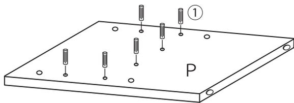
6 Rツール底版のダボ穴にPツール側板の木ダボを取り付けます。
