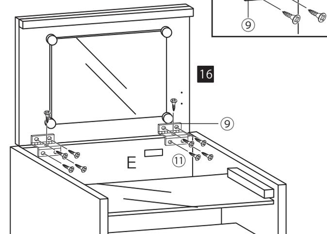
18 Cミラー扉とB右側板に⑦ステーを⑩ネジ中で仮止めします。(ミラー付扉側から先に取り付けて下さい。)Cミラー扉が開閉できるように調整しながら⑦ステーと⑨蝶番のネジを本締めします。E.背板のコンセント穴に⑧コンセントを⑫コンセント用ネジで取り付け、コンセントカバーをはめ込みます。コンセント裏面横に⑬コード止めをリード穴に沿って⑪ネジ小で取り付けます。
