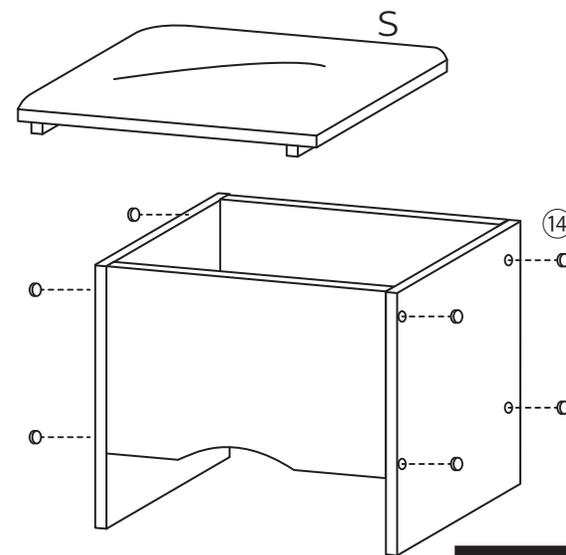
**10** A B左右側板のダボ穴に①木ダボ大を差し込みます。
