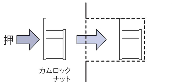
ボルトとナットが噛み合ったら、プラスドライバーでナットが止まるまで右に回してロックして下さい。
