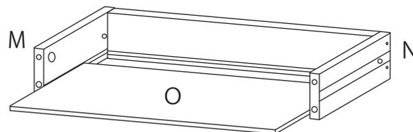
4 MN引出し左右側板のナット穴に⑤カムロックナットを差し込み、K引出し前板を取り付けます。
