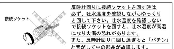
1. 「サーモ本体」上部の赤ラインと、接続ソケットの赤ラインを合わせると吐水温度が40°Cとなるように工場検査時に調整しています。
