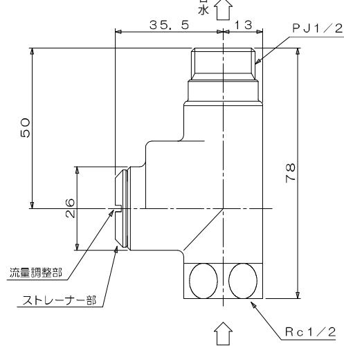
\*止水栓の取付けは流量調整部が必ずメンテナンス用開口部の正面になるように取り付けてください。
