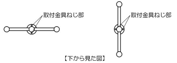
取付アダプタに取付金具をあわせ、固定リングで固定してください。
