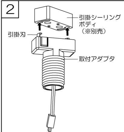
天井に取り付けられている引掛シーリングボディに取付アダプタの2本の引掛け刃を挿入します。
