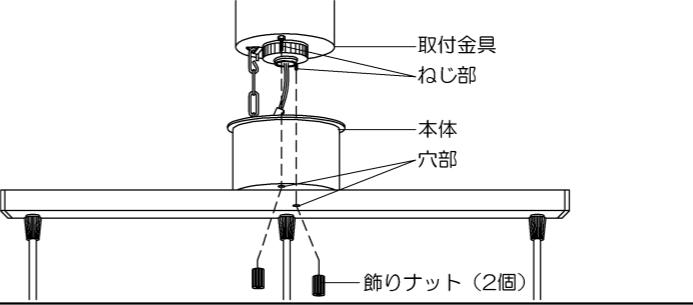
器具本体を持ち上げ、本体穴部に取付金具のねじ部を通し、飾りナット(2個)でしっかりと取り付けてください。
