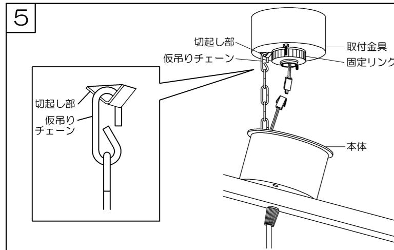
仮吊りチェーンの先端を取付金具の切起し部に引掛けてください。
