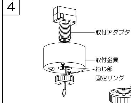
※器具の取付方向は、取付金具のねじ部方向によって決まります。
