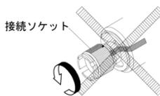
反時計回りに接続ソケットを回す時は必ず、吐水温度を確認しながらゆっくりと回して下さい。吐水温度を確認しないで接続ソケットを回すと、吐水温度が高温になり火傷の恐れがあります。また、反時計回りに回し過ぎると「パチン」と音がして中の部品が故障します。
