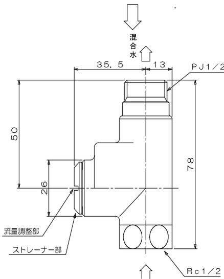
※止水栓の取付は流量調整部が必ずメンテナンス用開口部の正面になるように取り付けてください。
