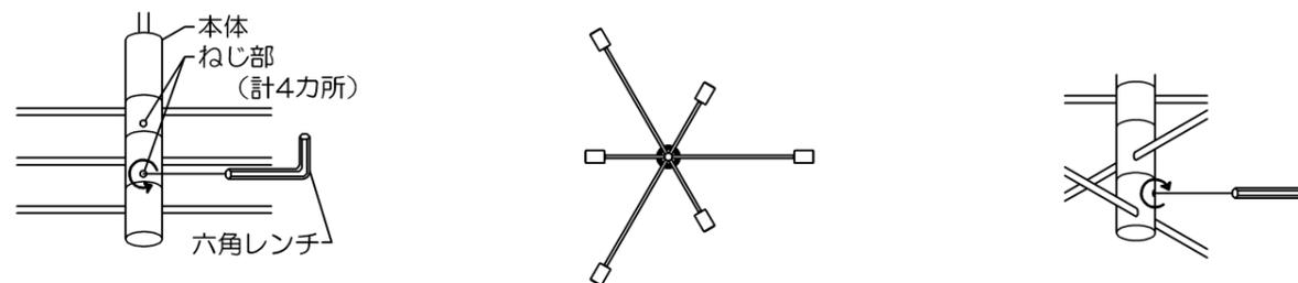
1.付属の六角レンチを使用し、本体のねじをゆるめます。ねじは下段に裏表各1ヶ所、中段に裏表各1ヶ所の計4ヶ所あります。
