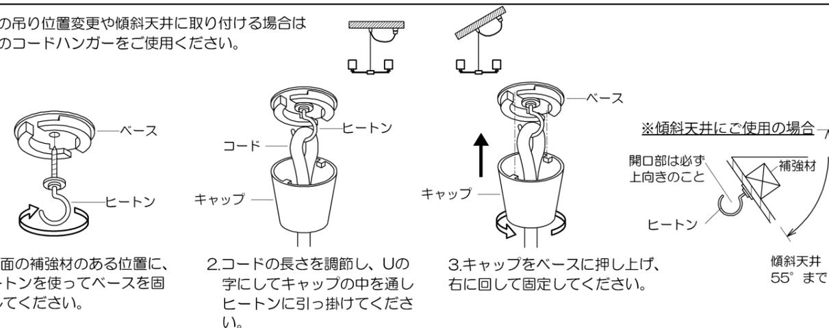
1.天井面の補強材のある位置に、ヒートンを使ってベースを固定してください。
