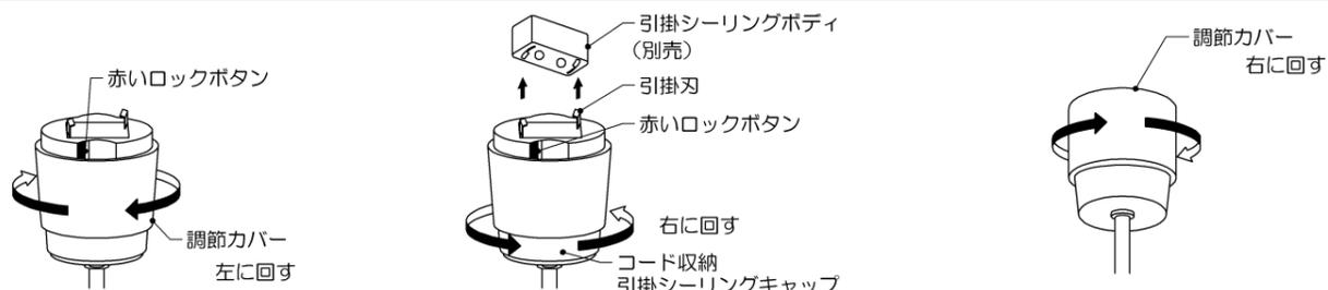
1.調節カバーを左に回して、赤いロックボタンが見えるまで調節カバーを下げてください。
