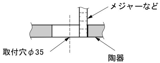
②位置決めナットの上端を水栓本体の溝の下端から測定した厚み分下げた位置にあわせる。
