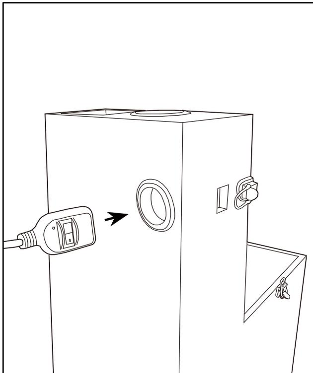
**3.** スイッチ固定ケースのフタを開けて、スイッチが外向きになるようにしてはめ込みます。
