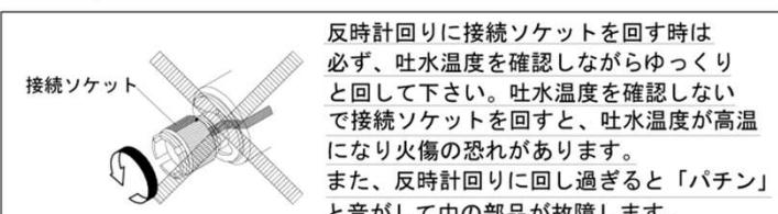
1. 「サーモ本体」上部の赤ラインと、接続ソケットの赤ラインを合わせると吐水温度が40°Cとなるように工場検査時に調整しています。
