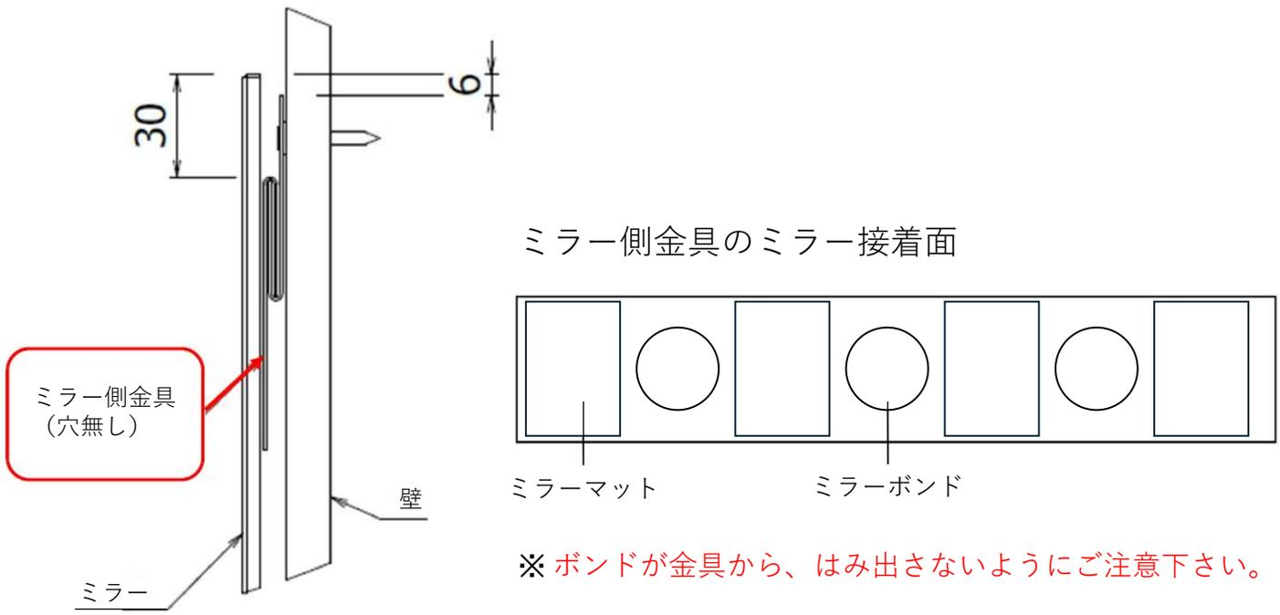
ミラー側金具のミラー接着面にミラーマット、ミラーボンドを上記のように貼り付け、塗布を行う。
