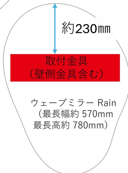
※ 取付位置・角度によっては、ミラー側金具がはみ出したり、壁側金具が正面から見えてしまいます。必ず計測を行い、取付られる事を確認してから作業を開始してください。
