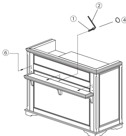
④棚板を取り付けて下さい。(角が欠けている棚板⑤が右側です。)
