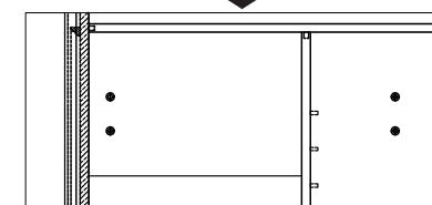
引出しを出します。図のようにレール部分の黒いレバーを、右側は下にさげ、左側は上にあげて、そのままの状態でゆっくりとレールから引出しを引き抜きます。
