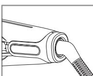
ピボットヒンジ(PIVOT HINGE)電源接続部 & 2次元360°回転コード
