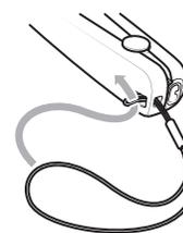
小さい輪をストラップ装着部に通し、その輪の中に大きい輪を通します。
